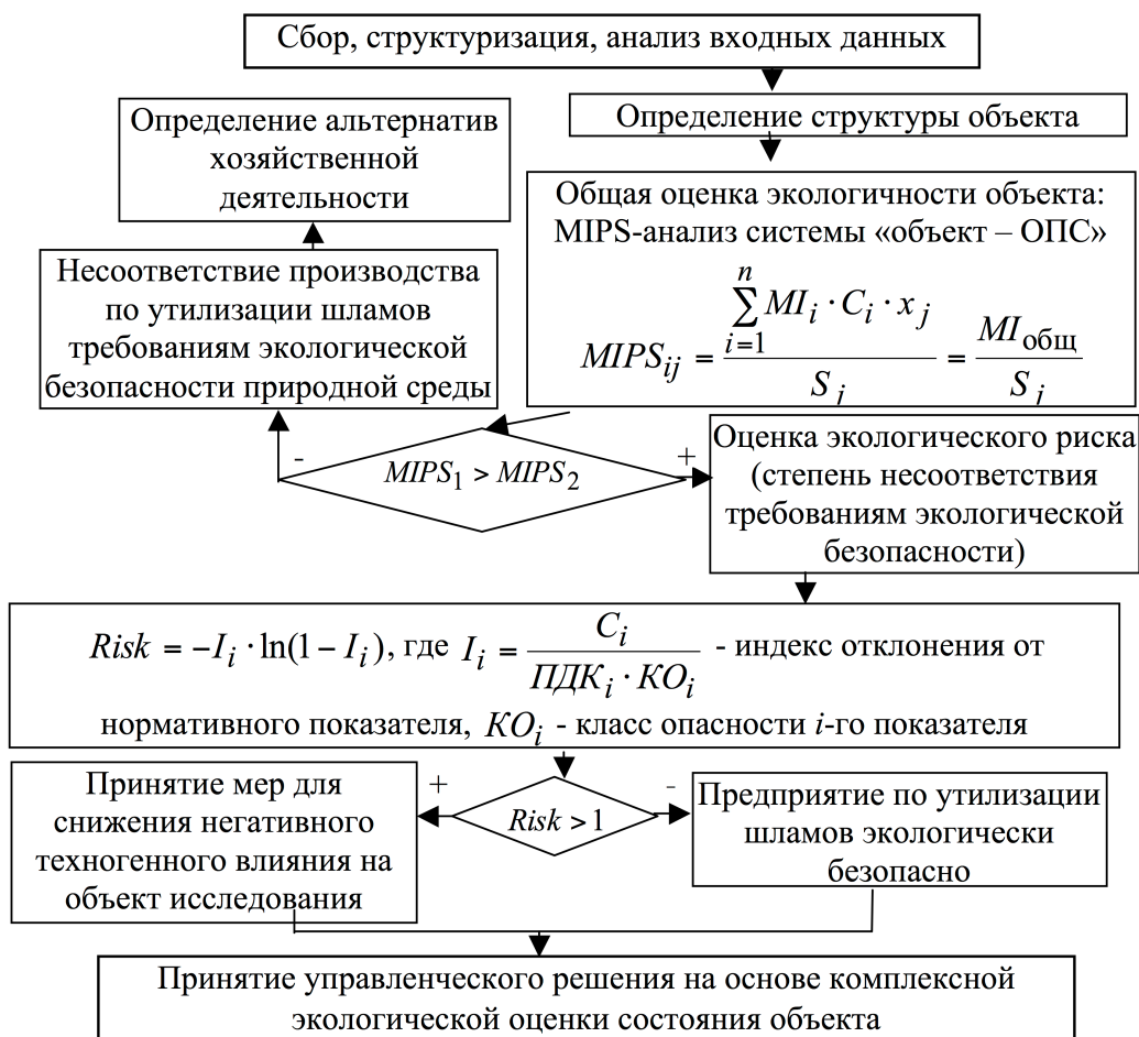
Рис. 1. Алгоритм комплексной оценки экологичности природно-техногенных объектов MI_i – материальная интенсивность i -го вещества (const), C_i – концентрация i -го вещества в j -й системе в количестве x_j , S_j – количество готовой продукции
